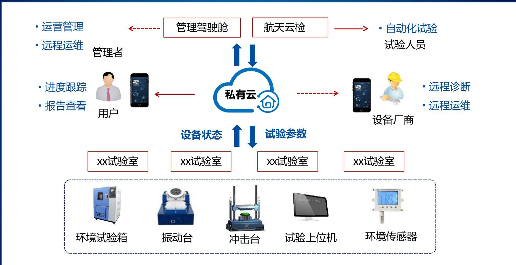
航天云检 (LIMS系统) 采用心通达数据中台解决方案, 实现设备互联互通与数据管理与价值利用: 1、对实验设备进行全面管控, 提供设备异常和故障实时报警; 2、试验数据系统化管理、提供检索能力和融合分析能力; 3、实现试验设备与上层信息系统互联互通, 试验参数可直接下发到设备, 试验数据自动采集; 4、管理决策支持, 真实反应任务执行效率、完成率、维护需求等情况。
